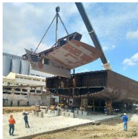
2. Transferencia y volteo de las secciones U07+U17
